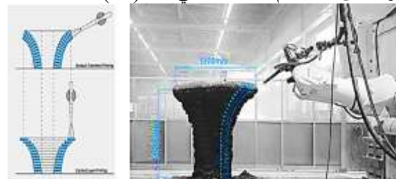
شكل (١٧) يوضح استخدام الخرسانه في التصنيع الرقمي بالفراغات الدخانيه مثل تصميم الأعمده معقده الشكل بواسطه الطباعه ثلاثية الأبعاد.
