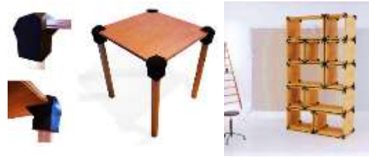
شكل (٣) يوضح تصميم قطع أثاث مختلفه بواسطة الطباعة ثلاثية الأبعاد و استخدام زوايا التجميع الخاصه بهذه التقنية. المصدر :
