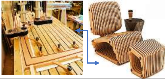
شكل (٤) يوضح التصميم المختلف لقطع الأثاث بواسطة آلة التقطيع باستخدام الحاسوب المصدر : https://www.cnccookbook.com/cnc-chair-plans-paw-chair/
