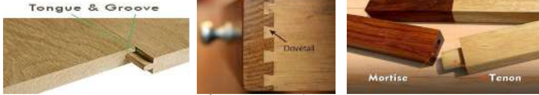
شكل (٦) يوضح نماذج للوصلات الصناعية.
