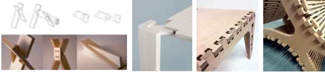
شكل (٩) يوضح بعض التشعيقات بواسطة ماكينات القطع و باستخدام الروتر Routers في عمل تشعيقات خشبية رقمية.
