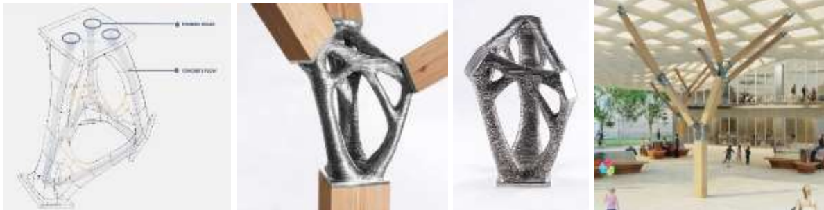
شكل (٢٧) يوضح وحده التجميع أو الموصل الفولاذي الهيكلي المصنوع بتقنية ال 3D Printing لتجميع بعض الاجزاء الخشبية كالتغطيات. جدول (٢) يوضح المقارنة بين القديم أو التقليدي والحديث في تقنيات التصنيع للأثاث.
