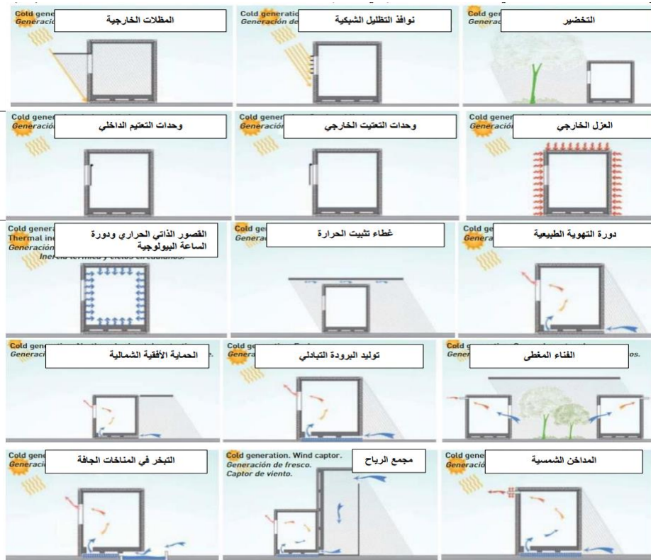
شكل (٢٠) طرق وأساليب التبريد المختلفة لحاوية الشحن كمعالجات معمارية.
