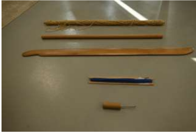
الشكل رقم (1): الآلات المستخدمة في نسج خيوط السدو (الميشع، المنشزة، المدراة)
