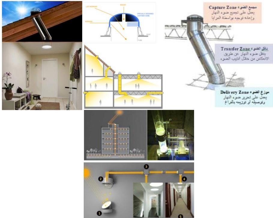
شكل (١٧) يوضح نظام Light Pipes وطريقة عمله لتوصيل الأضواء الطبيعية بكفاءة عالية
