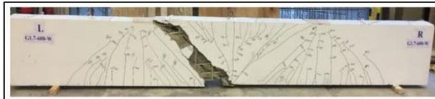
(d) Experimental crack pattern
