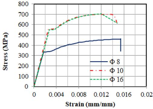
(d) Stress-strain curve for steel stirrups
