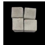
صورة رقم (2) توضح العينات التي تم إعدادها من سيليكات + مسحوق حجر جيري + جير حي + لاتكس
