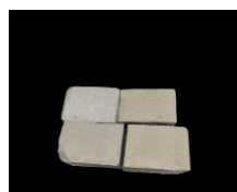
صورة رقم (5) توضح العينات التي تم إعدادها من مسحوق حجر جيري + سيليكات + أسمنت أبيض معالج + لاتكس
