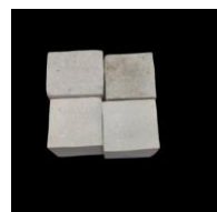
صورة رقم (3) توضح العينات التي تم إعدادها من مسحوق حجر جيري + أيبوكسي
