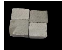
صورة رقم (4) توضح العينات التي تم إعدادها من مسحوق حجر جيري + سيليكات + أسمنت أبيض معالج + لاتكس + 20% self leveling
