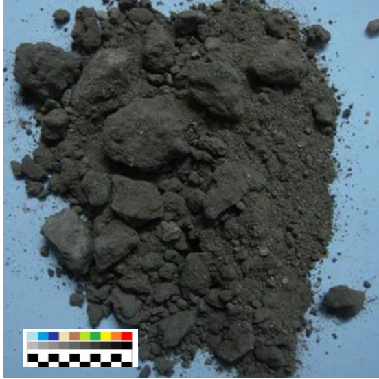
صورة (17): فحص بصري لعينة من المونة الطينية الرابطة بين قوالب الطوب اللبن، ترتفع بها نسبة الرمل والحصى.
