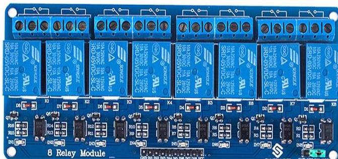
**Fig. 22. Relay module.**
