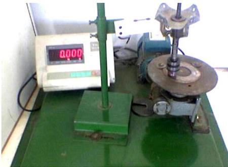
Fig. 1 Pin-on-Disk test rig.
