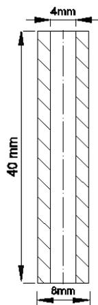
Fig. 1. Test Specimen.
