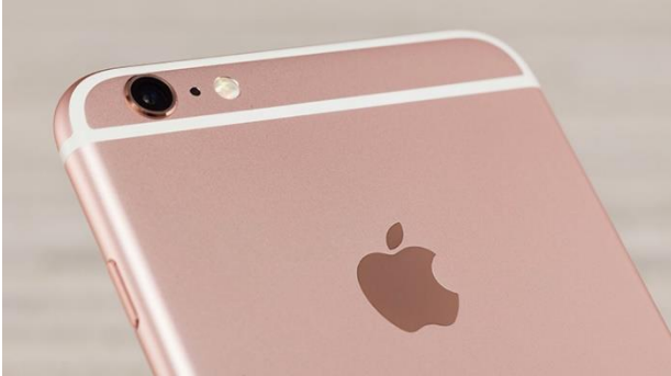
شكل رقم (٤) مثال يوضح فهم المصمم للمكونات الداخلية حيث تم وضع هذه الخطوط البيضاء أعلى الجهاز كشكل جمالي ولكنها في الحقيقة مستشعر إشارات الاتصال التي لا يمكن أن تكون داخل الجهاز بسبب الجسم الألومنيوم الذي يحجب إشارة الاتصال (Ryan, 2015).
