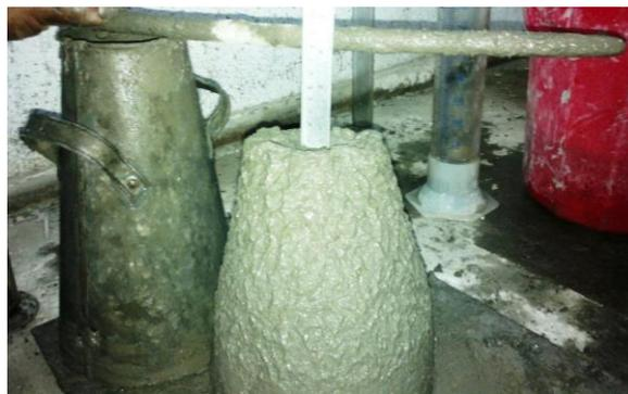
**Fig. 6.** Slump test
