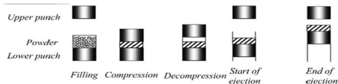
**Fig. 2:** Compression Process<sup>19</sup>
