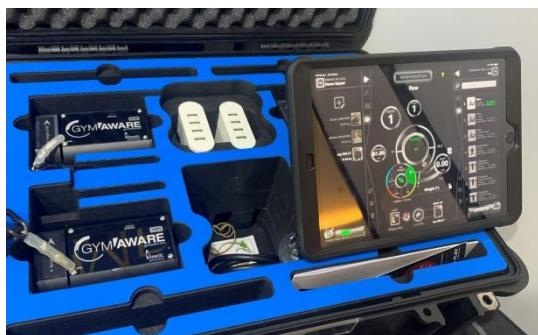
، Linear Position Transducers وهي تقنيات تعتمد على مقياس التسارع لمراقبة سرعة الحركة لتحقيق أهداف أداء محددة ، بالإضافة إلى التنظيم الذاتي الموضوعي والذي يستخدم لمراقبة أداء تدريب المقاومة <https://gymaware.com>. (٢٢)
