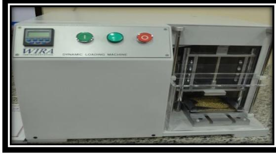
صورة (3) توضح جهاز فحص التحميل الحركي للسجاد
