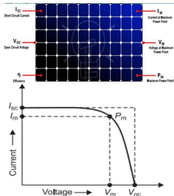
Figure 1 Solar cell parameters
