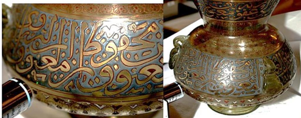
لوحة (٢١): لوحة للمشكاة اثناء عمل الفحص الاشعاعي باستخدام اشعة الليزر بمعامل متحف اللوفر
