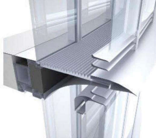
شكل (8) فتحة دخول الهواء (أيروفويل) التي تسمح بدخول الهواء النقي إلى تجويف الغلاف المزدوج. لمبنى Bligh Street-Meyer, U. (2008)
