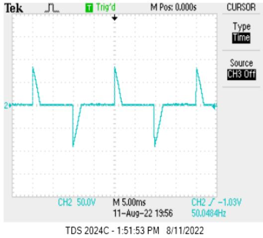
(d)  $\alpha=147.6^\circ$  at  $R_2 = 190 \text{ k}\Omega$
