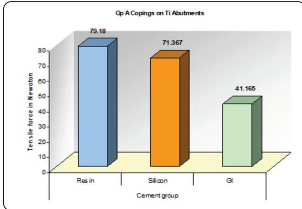
Fig. (3) Tensile test
