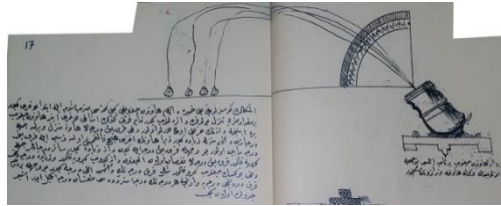
(شكل ٥٧) استخدام ميزان الربع لضرب التحصينات بما يعرف بالضرب الرأسي عند مصطفى بن ابراهيم "فن خميرة" ورقة ١٧.
