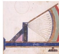
(شكل ٤٢) ميزان الربع او قنداد المكحلة ذو الثلاث عشر درجة . الزردكاش الاسلحة ورقة ٧٦
