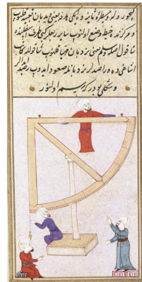
(شكل ٣٦) آلة الربع الخشبية كما وصفها مؤيد الدين العرضي (ت ١٦٦٤هـ/ ١٢٦٦م). عن: Fuat Sezgin, Science and Technology in Islam V 2p.58
