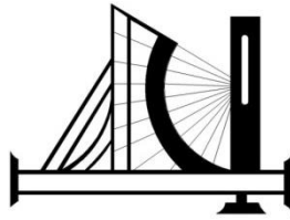
(شكل ٤١) رسم تخطيطي لميزان الربع ذو الاحدى درجات طبقا لوصف الزردكاش . عمل الباحث
