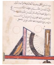
(شكل ٤٠) ميزان الربع او قنداد المكحلة ذو الاحدى درجات . الزردكاش الاسلحة ورقة ٧٥
