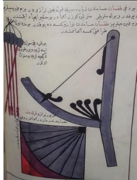
(شكل ٦٤) طرز مختلفة من ميزان الربع لضرب التحصينات بما يعرف بالضرب الرأسي عند بيرم اغلي "أم الغزا" ورقة ٦٠
