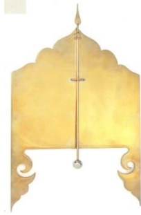
(شكل ١١) ميزان الأرض. مخطوط ابن ارنبا الزردكاش، ورقة ٣٧.
