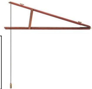
(شكل ٢٢) آلة قياس الارتفاعات والمسافات صممت على أساس يعقوب بن اسحق الكندي (ت بعد ٢٥٦هـ/٨٧٠م). متحف بمعهد تاريخ العلوم العربية والإسلامية . جامعة فرانكفورت
