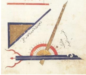
(شكل ٩) ميزان القريب والبعيد لقياس الارتفاعات والمسافات. رسم طبقا لوصف الزردكاش. عمل الباحث
