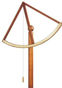
(شكل ٣٦) آلة الربع الخشبية كما وصفها مؤيد الدين العرضي (ت ١٦٦٤هـ/ ١٢٦٦م). عن: Fuat Sezgin, Science and Technology in Islam V 2p.58
