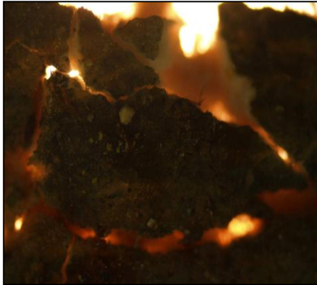
صورة (٧) توضح انفجار الثقوب المصاحب للتشققات والحفر
