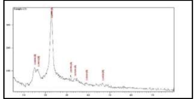
شكل رقم (٧) يمثل تحليل العينة الورقية بواسطة حيود الأشعة السينية .
