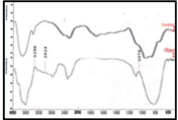
شكل رقم (٨) يمثل تحليل العينة اللاصق بالمخطوط بواسطة تفلور الأشعة تحت الحمراء .
