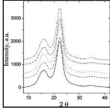
شكل رقم (٩) قياس قمة انعكاس السيلولوز في تحليل حيود الأشعة السينية. واتضح من الشكل رقم (٩) عند تطبيق المعادلة أن مؤشر التبلور
