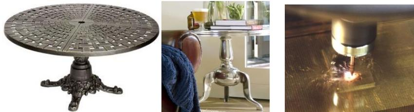
شكل (25) الأعمال المعدنية عن طريق تقنية EDM وهي عملية إزالة المعدن بالشرر الكهربائي التي تحرق المعدن
