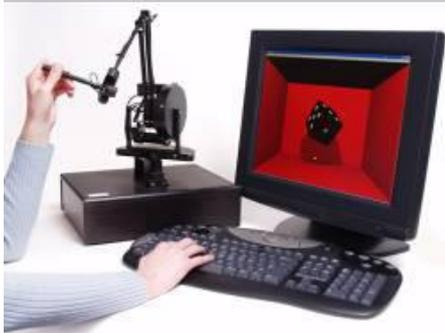
شكل (19) جهاز الفانتوم هو عبارة عن جهاز ادخال بيانات يعتمد على الاستجابة للمسية ويعرف ايضا بجهاز الاستجابة بالقوة
