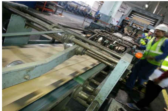
Fig. 9. Sacks stick (tubing)
