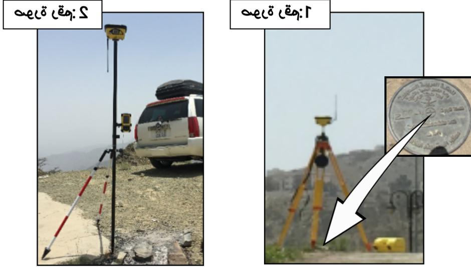
شكل (3) صورة رقم 1: نقطة إحكام أرضية معلومة الإحداثيات (GCP) مثبت عليها جهاز القاعدة Base؛ صورة رقم 2: جهاز متحرك Rover لرصد نقاط الإحكام الأرضية الجديدة.
