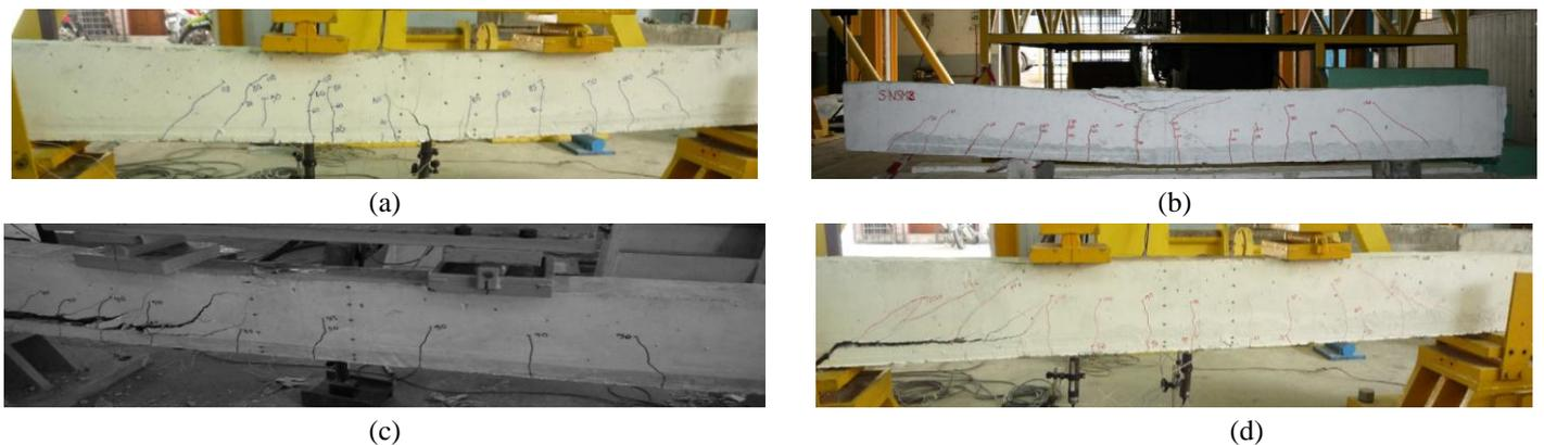
Fig. 16: Failure modes of tested beams; (a) PSNC8, (b) SNC10, (c) SNC12 and (d) PSNC12 [39].
