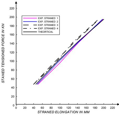
FIG.(4.1b) EXPERIMENTAL & THEORTICAL ELONGATION OF TENDON 2
