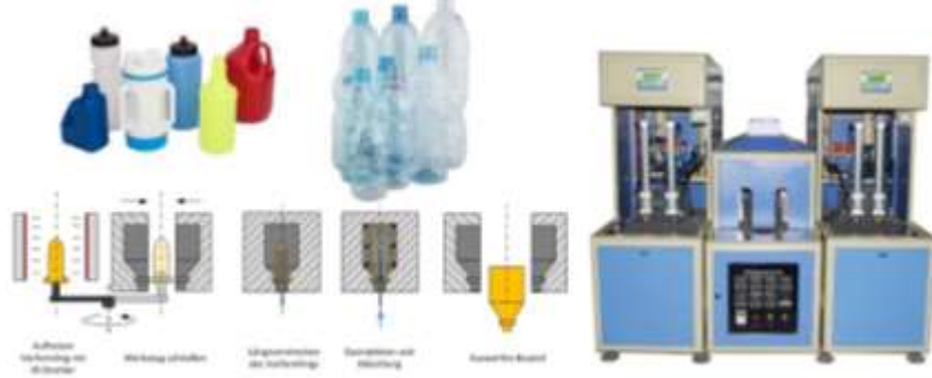
شكل ٢: ماكينة النفخ ونظريه عملها
