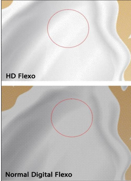
شكل رقم (١٣): يوضح الفرق بين التنفيذ بتقنية الفلكسوجراف الرقمي عالي الدقة ومحاكاة التنفيذ بتقنية الفلكسوجراف الرقمي التقليدي لمناطق الإضاءة العليا.
