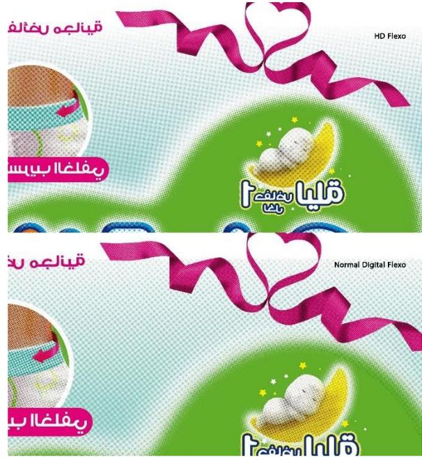
شكل رقم (١٧): يوضح الفرق بين التنفيذ بتقنية الفلكسوجراف الرقمي عالي الدقة ومحاكاة التنفيذ بتقنية الفلكسوجراف الرقمي التقليدي ويظهر الفرق بوضوح في تدرجات الأرضية لأعلى وأسفل
