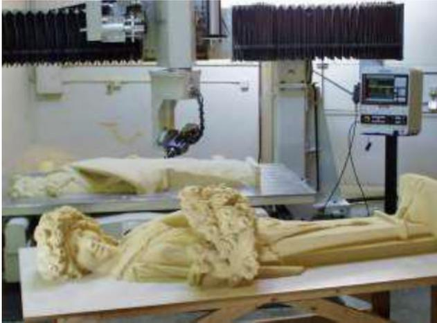
شكل (١٢) استنساخ تمثال ذات مقياس صرحى من تمثال أثري من خلال تقطيع الشكل بواسطة ماكينة سي إن سي بعد استنساخ جميع التفاصيل بواسطة الماسح الضوئي ( تجربة جاليري بورغيز).
