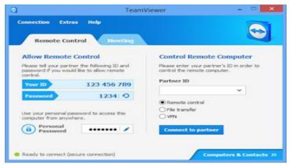
فور تبليغ ID يقوم الطرف الآخر بإضافته في Partener ID ثم Disconnect to partener ثم إدخال password ، بعد هذا الإجراء سيتم الاتصال ويفتح شاشة جهاز الكمبيوتر داخل جهازالمتحكم.
