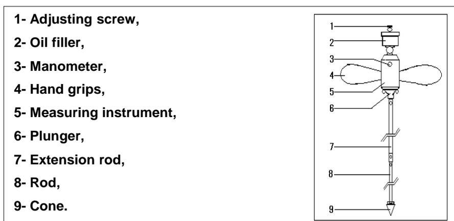
Fig. 1: Hand Penetrometer
