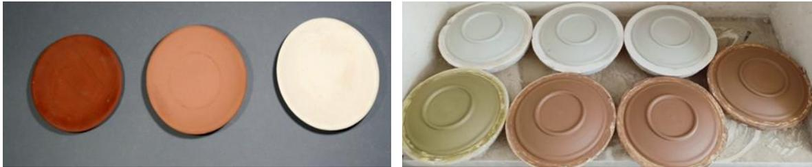
شكل رقم ( ١٥ ) نموذج يوضح كيفية تشكيل أطباق عن طريق استخدام السادف من الخارج والداخل للطينات السابقة الثلاثة ( C3 ) ، ( B2 )، (A1) و حرقها على درجة ١٠٥٠ درجة مئوية و تشوهت (A1) في درجة الحريق هذا ونتج عنها انكماش عالي ولون بني قاتم .
