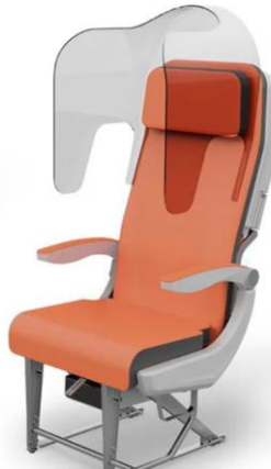
( الشكل 7 ) يوضح المقترح لتفعيل الإجراءات الوقائية لمقاعد الطائرة على الجانبين توضح الشركة. فى هذه الأثناء ، يتم توجيه الركاب الجالسين على المقاعد الجانبية فى اتجاه الرحلة. كل مقعد محاط من ثلاث جهات بدرع يمنع التنفس من المرور مباشرة إلى المقاعد المجاورة. يسمح الترتيب بفصل جميع الركاب الثلاثة على التوالي عن بعضهم البعض ، وكذلك عن المضيفات الذين يستخدمون الممر. مصنوع من مواد آمنة وسهلة التنظيف ، متوفر بمادة غير شفافة أو بدرجات مختلفة من الشفافية.
