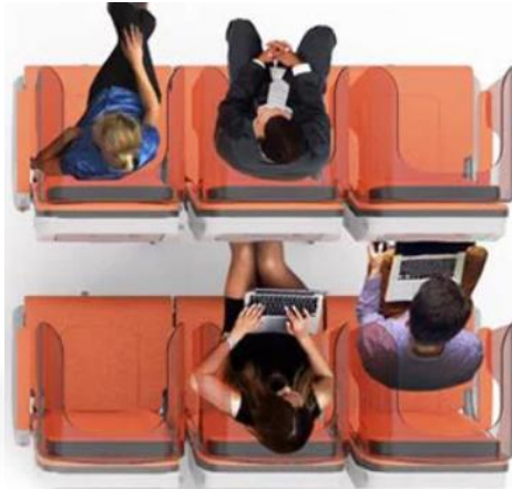
( الشكل 7 ) يوضح المقترح لتفعيل الإجراءات الوقائية لمقاعد الطائرة على الجانبين توضح الشركة. فى هذه الأثناء ، يتم توجيه الركاب الجالسين على المقاعد الجانبية فى اتجاه الرحلة. كل مقعد محاط من ثلاث جهات بدرع يمنع التنفس من المرور مباشرة إلى المقاعد المجاورة. يسمح الترتيب بفصل جميع الركاب الثلاثة على التوالي عن بعضهم البعض ، وكذلك عن المضيفات الذين يستخدمون الممر. مصنوع من مواد آمنة وسهلة التنظيف ، متوفر بمادة غير شفافة أو بدرجات مختلفة من الشفافية.
