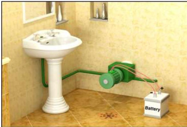
شكل (14) يوضح وحدة توليد الطاقة من تدفق الماء بالمواسير داخل المنازل
