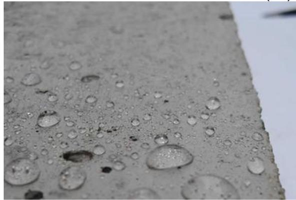
شكل رقم (6) يوضح الخرسانة المقاومة للماء والمستخدمه فى الاماكن الممطره للحفاظ على الخرسانه المسلحه من تأثير الرطوبه التى قد تتسبب فى أحداث تلفيات بها - المصدر : (13)
