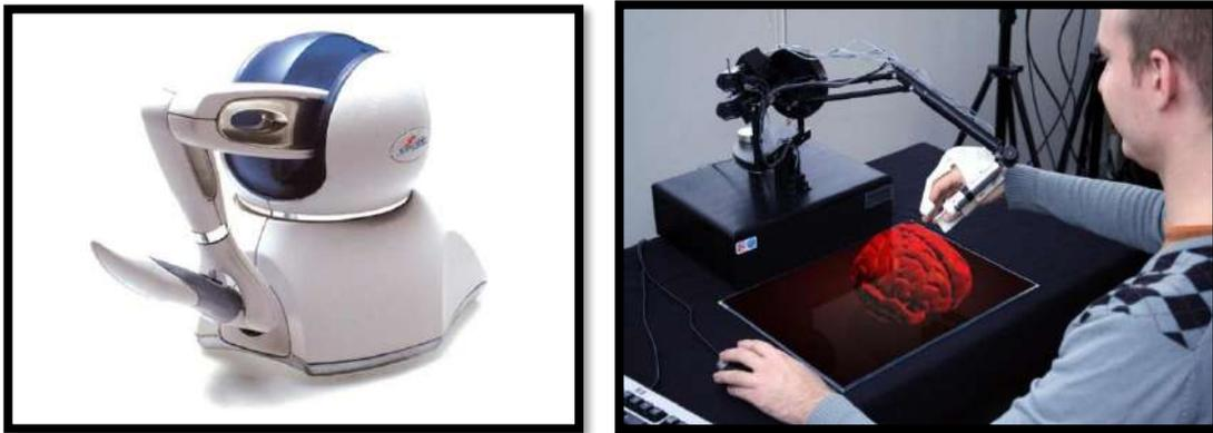
شكل ( ١٧ ) جهاز الإحساس باللمس Phantom
