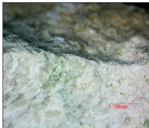
(صورة ٤) تمثل صورة بالمجهر الرقمي بقوة تكبير 1, (031 MM) لجزء من العينة توضح الأملاح المتبلورة على السطح ©تصوير الباحث
