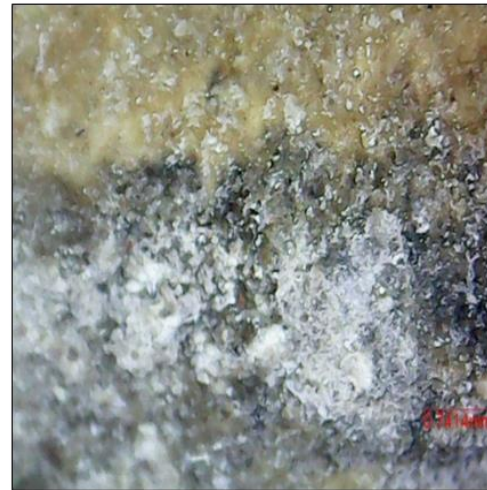
(صورة ٤) تمثل صورة بالمجهر الرقمي بقوة تكبير 1, (031 MM) لجزء من العينة توضح الأملاح المتبلورة على السطح ©تصوير الباحث
