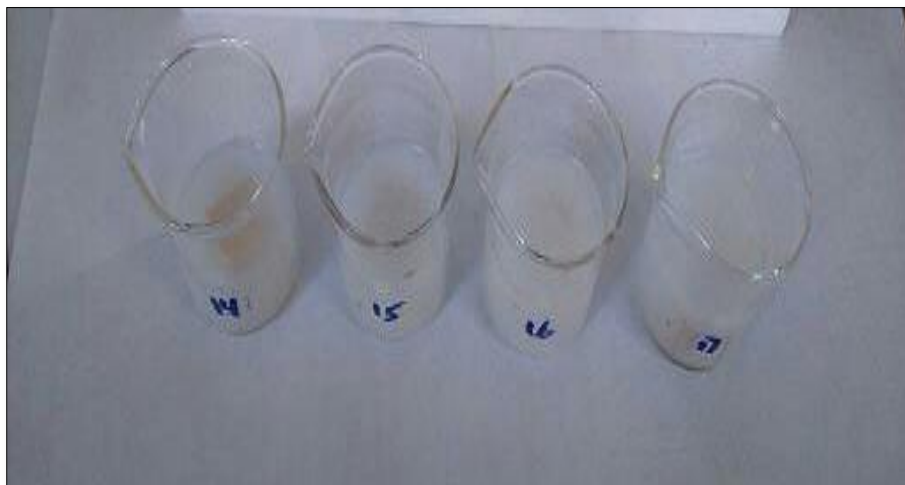
(صورة ٢) توضح عينات الحجر الجيري التجريبية مغمورة في محلول جزيئات أكسيد الزنك النانوية * ©تصوير الباحث
