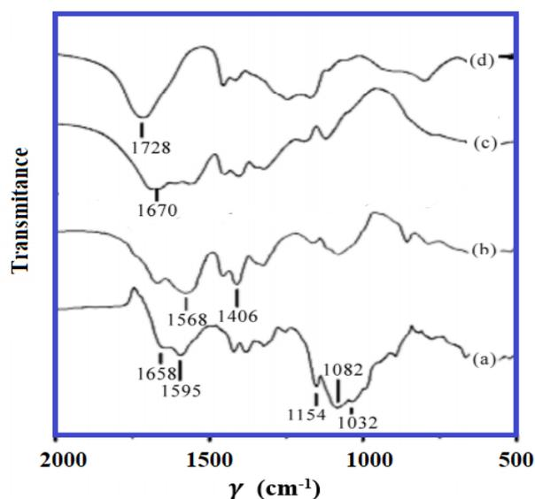
Figure (1) FTIR for (a)Chitosan (b)Ch- g- (Am-co-AA) (c)Am and (d) AA
