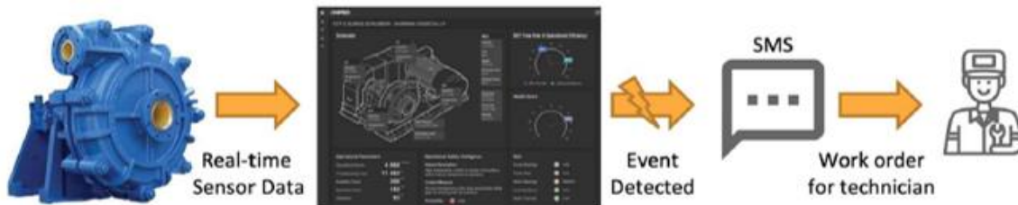
شكل رقم (٣) يوضح مراحل التوائم الرقمي في تشخيص وتحليل الأعطال وإرسال SMS للفني لبدء الإصلاح [٢٠]
